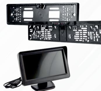
Universelle Rückfahrkamera, die sich im Kennzeichenrahmen befindet.
