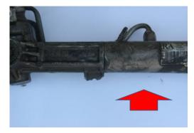
Keine Beschädigung der Befestigungspunkte des Gehäuses
