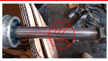
An der mit einem roten Feld gekennzeichneten Stelle ist zu erkennen, dass die Getriebe aufgrund einer früheren Erosion poliert wurde. In diesem Fall ist der Durchmesser kleiner als das Original, sodass keine Originalteile (Gummidichtungen) zur Regeneration verwendet werden können.
